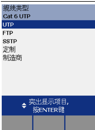
图 7: UTP 表示非屏蔽, FTP 表示单屏蔽, SSTP 表示双屏蔽
